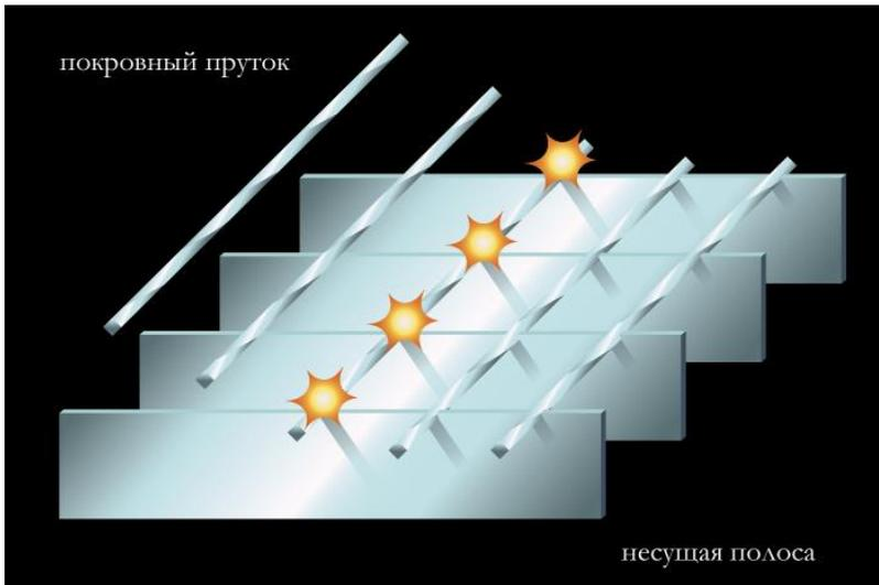
Решетчатый настил представляет собой сварную конструкцию, состоящую из стальных элементов в виде продольных и поперечных полос. Такие изделия отличаются высокой прочностью, надежностью и устойчивостью ко всем видам износа (механический, коррозионный). Продольные полосы являются несущими, а поперечные элементы предназначены для соединения конструкции в единое целое и придания настилу необходимой жесткости.
